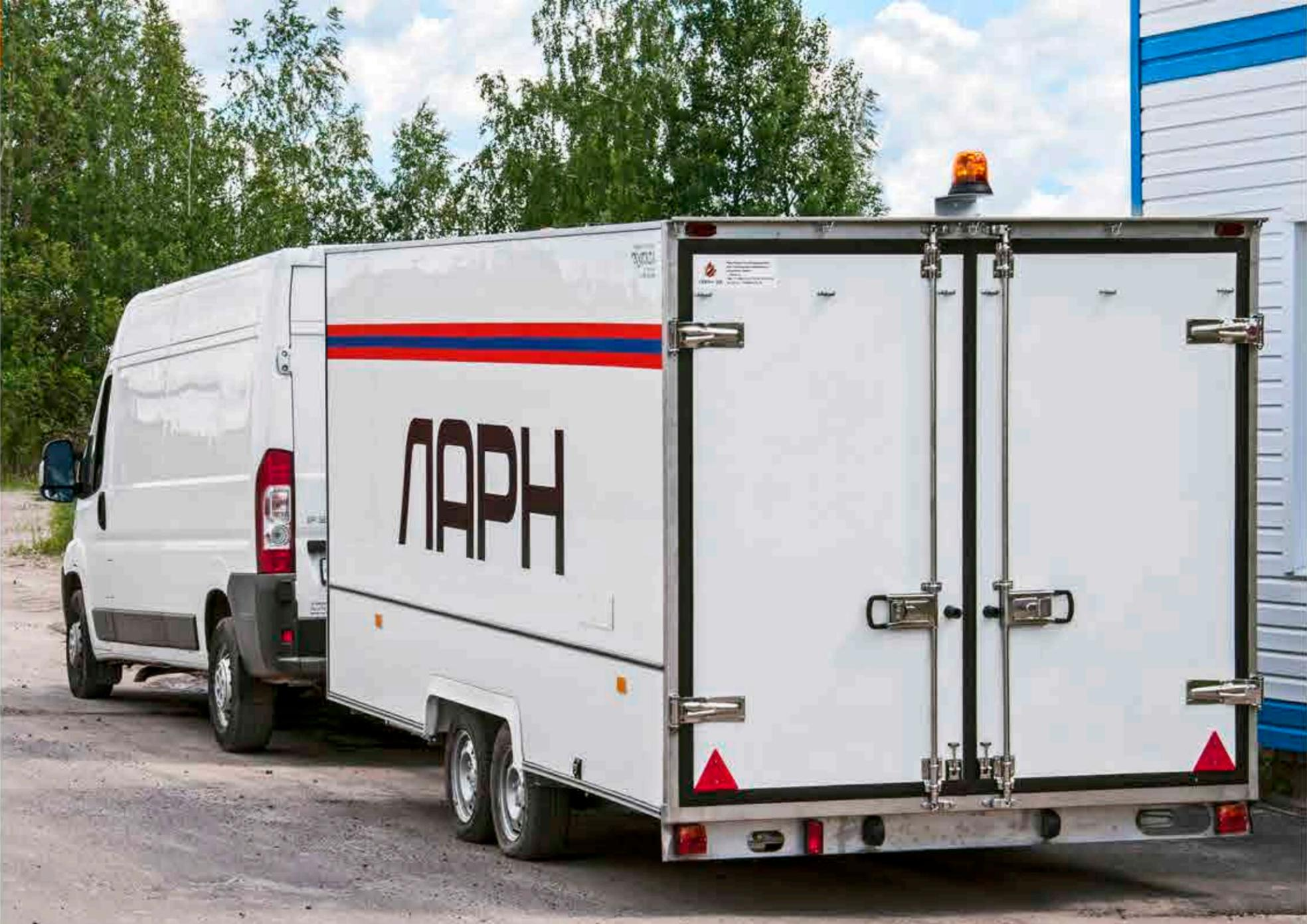
**Комплекс «ЛАРН 100 Базовый» - это комплект материалов и средств для ликвидации аварийных разливов нефти при плюсовых температурах, складированные на базе ж/д контейнеров, автомобилей или автоприцепов для удобства их доставки к месту аварийного разлива нефти.**
