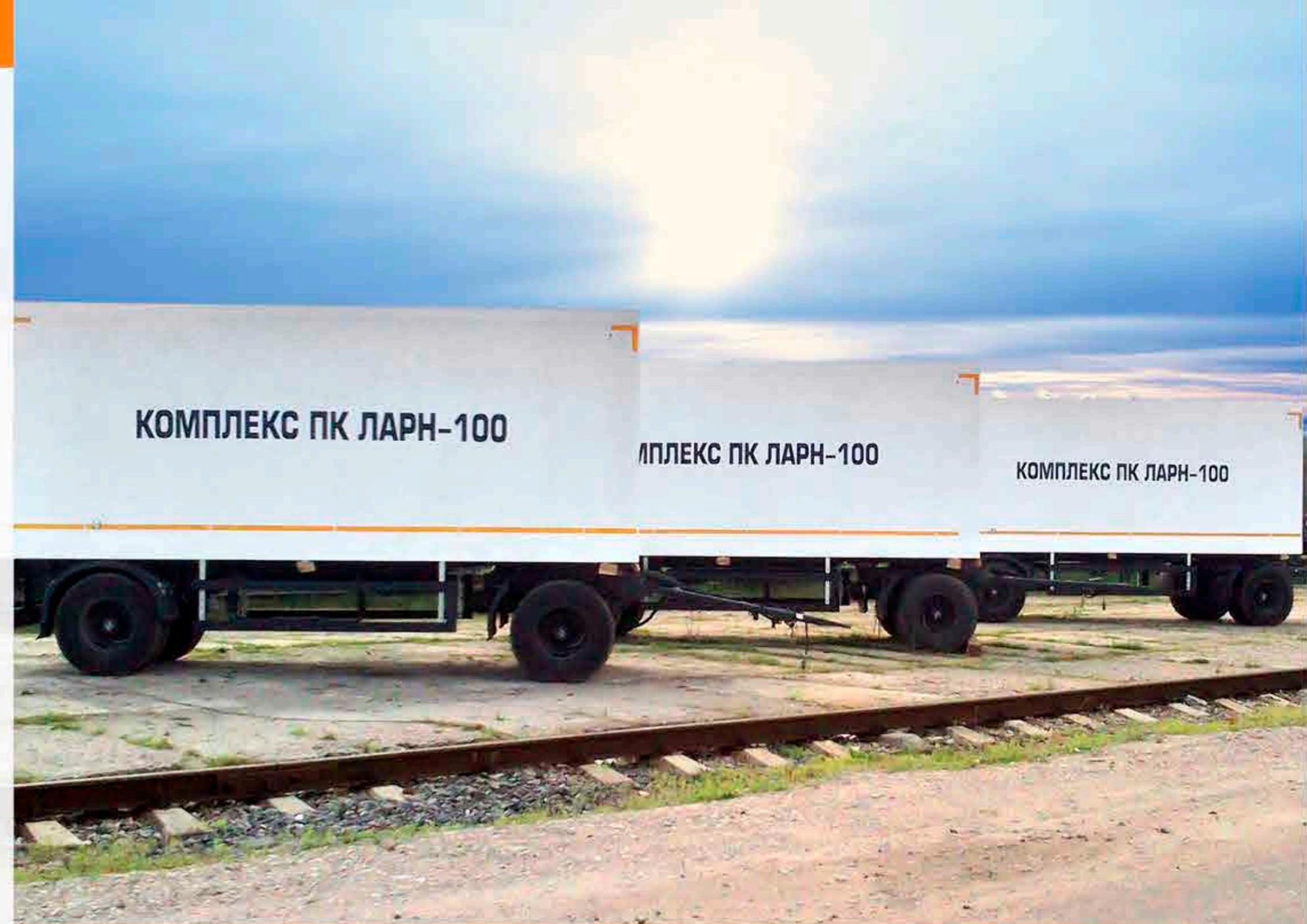
**Комплекс «ЛАРН 100 Оптимальный» - это комплект материалов и средств для ликвидации аварийных разливов нефти, скомплектованные на базе ж/д контейнеров, автомобилей или автоприцепов для удобства их доставки к месту аварийного разлива нефти.**
